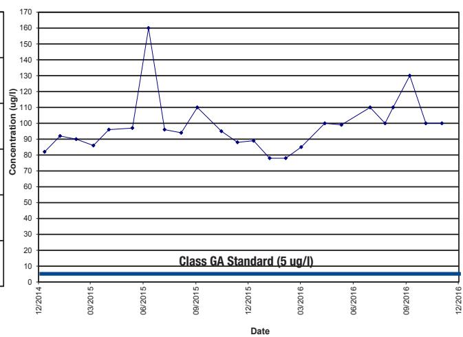
**Aqueous-Phase Air Stripper Effluent Concentration Ranges**
