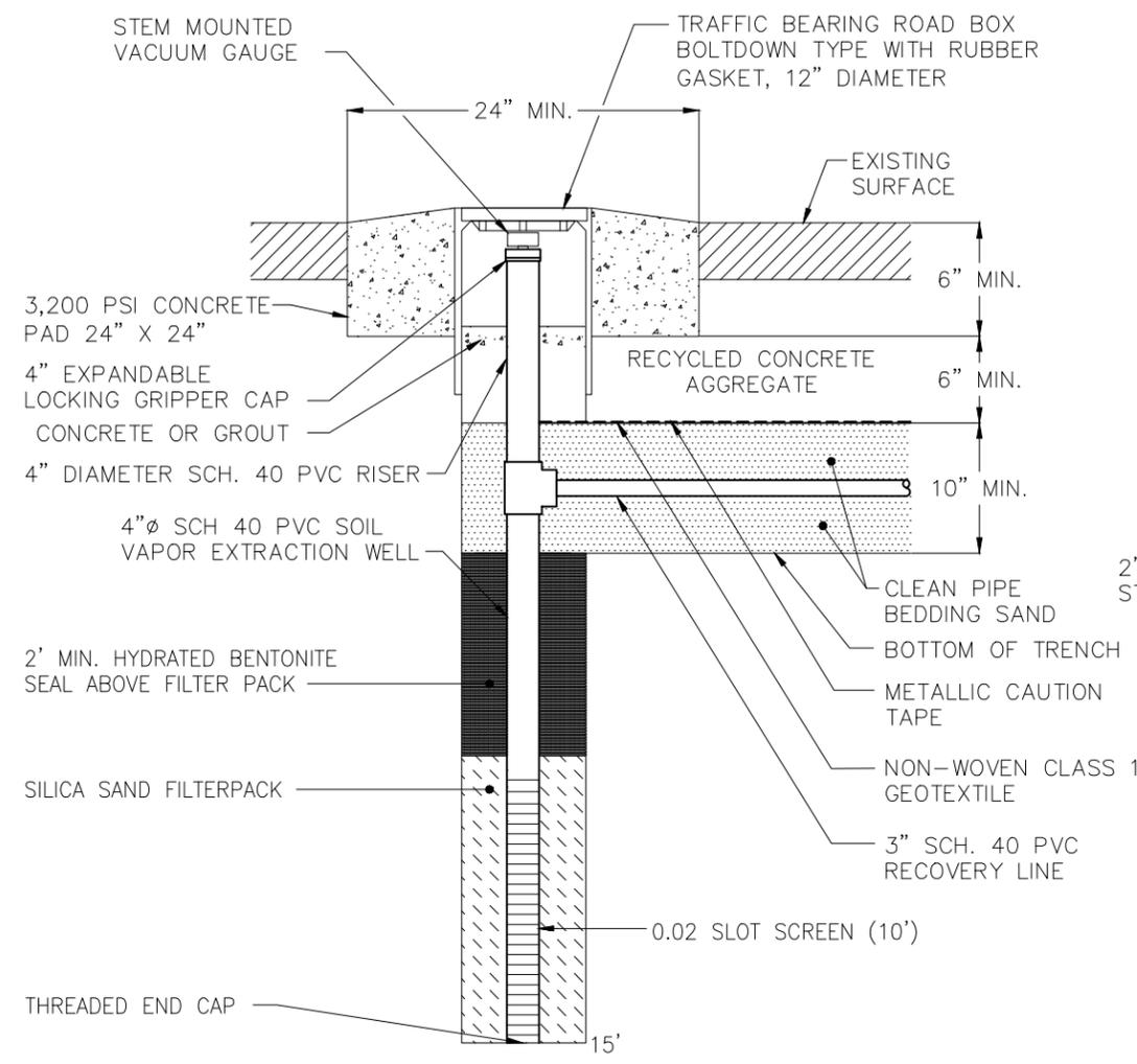
**SOIL VAPOR EXTRACTION WELL DETAIL**
