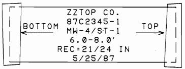
SAMPLE JARS FROM THE TOP AND BOTTOM OF THE TUBE SHOULD BE MARKED: MW-4/ST1-TOP MW-4/ST1-BOT
