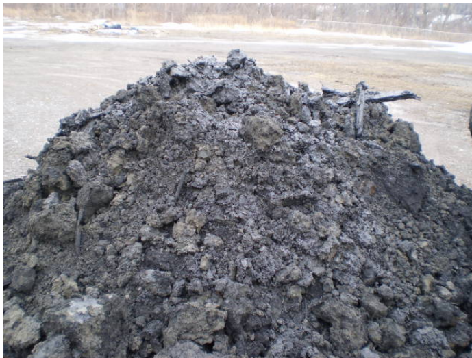
Rocky slag fill spoils, heavy petroleum odor
