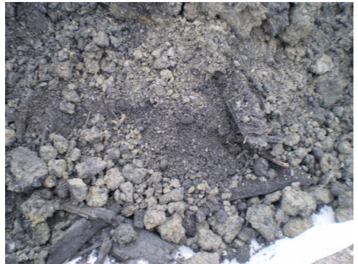
Rocky slag fill spoils, heavy petroleum odor
