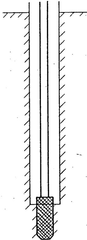
SAMPLER DRIVEN BELOW CASING
