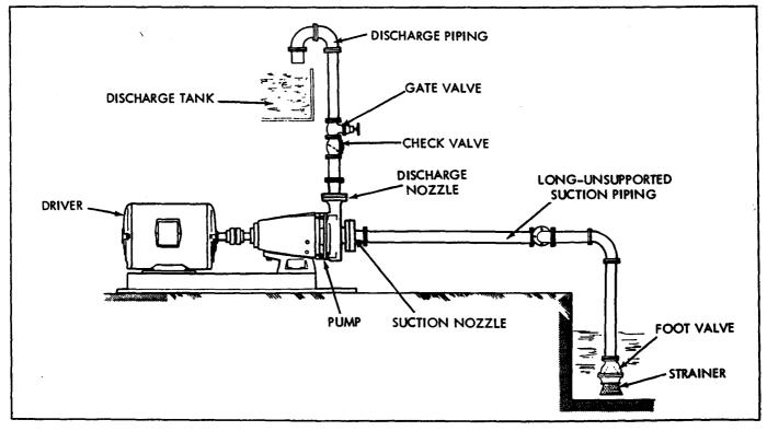
FIGURE 2. UNSATISFACTORY LOCATION - LONG INDIRECT SUCTION WITH NO SUPPORT
