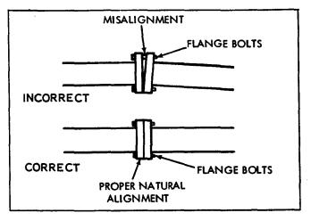
FIGURE 22. PIPE ALIGNMENT
