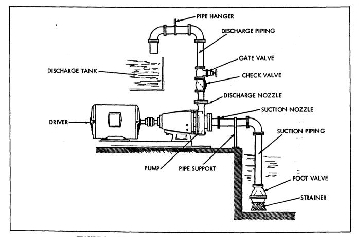
FIGURE 1. RECOMMENDED LOCATION - SHORT DIRECT SUCTION
