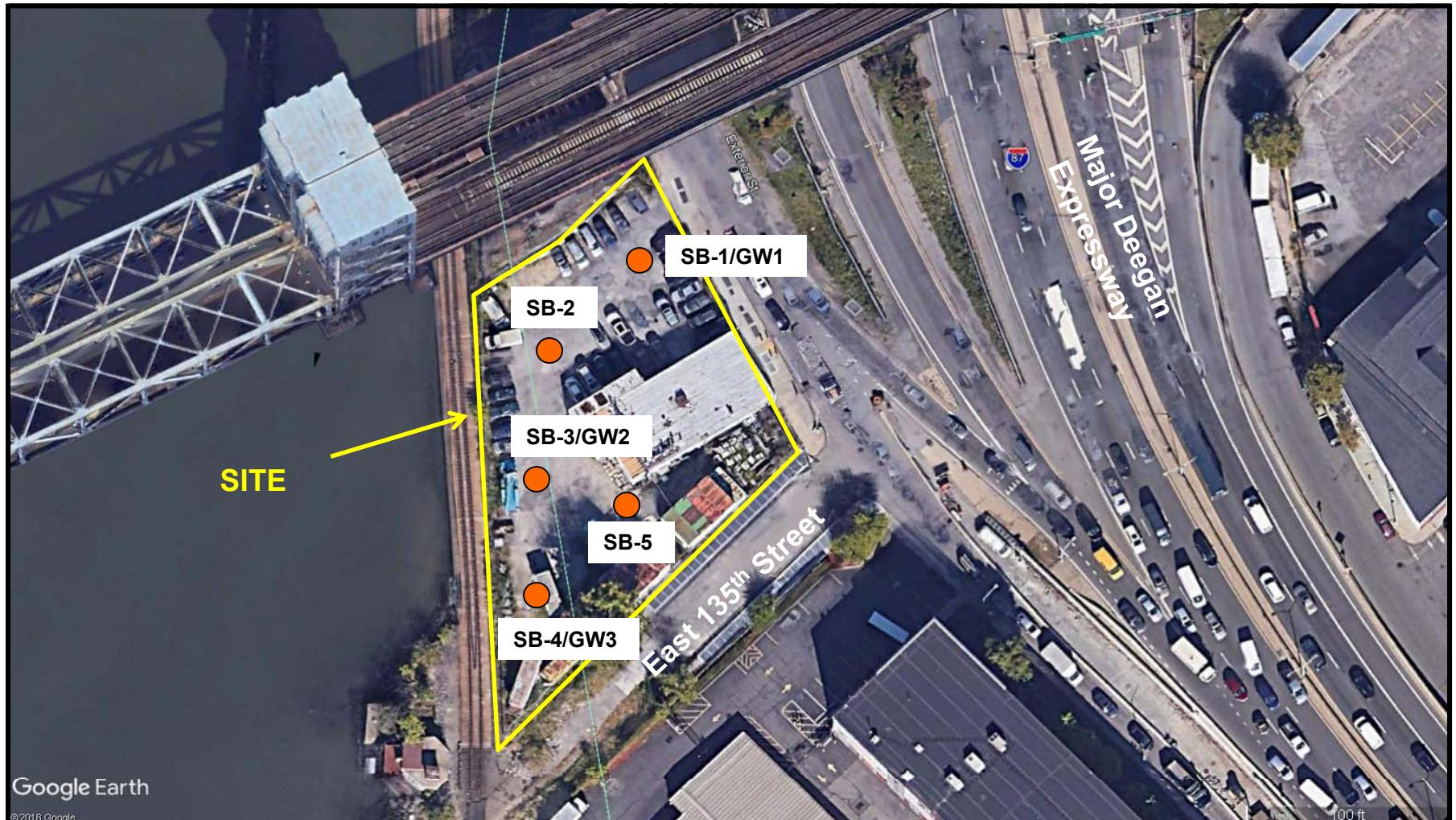
**FIGURE 2 - SOIL BORING AND GROUNDWATER SAMPLE LOCATION MAP**
