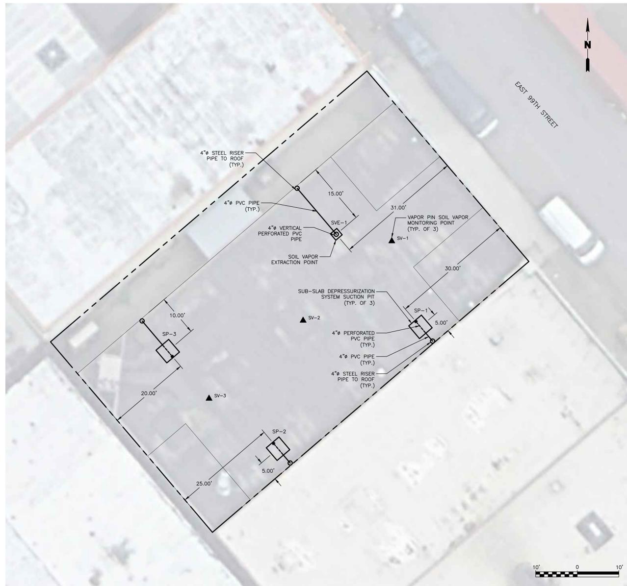
SOIL VAPOR EXTRACTION SYSTEM/SUB-SLAB DEPRESSURIZATION SYSTEM PLAN
