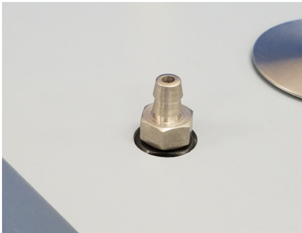
Figure 6. Mini Vapor Pin® Installation Complete
