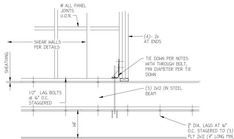
**TYP. SHEAR WALL ON STEEL BEAM**
