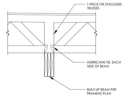
**MID-SPAN TRUSS SUPPORT** 9
