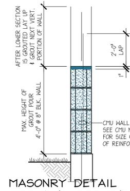
**MASONRY GROUTING SEQUENCE** 19
