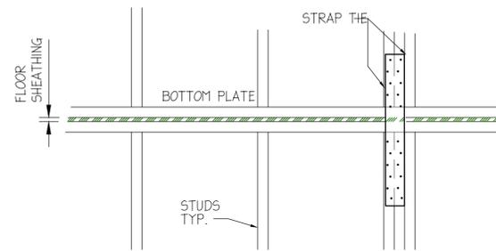
**TYP. TIE DOWN BETWEEN FLOORS @ SHEAR WALL ENDS**
