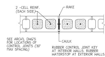
**MASONRY CONTROL JOINT** 17
