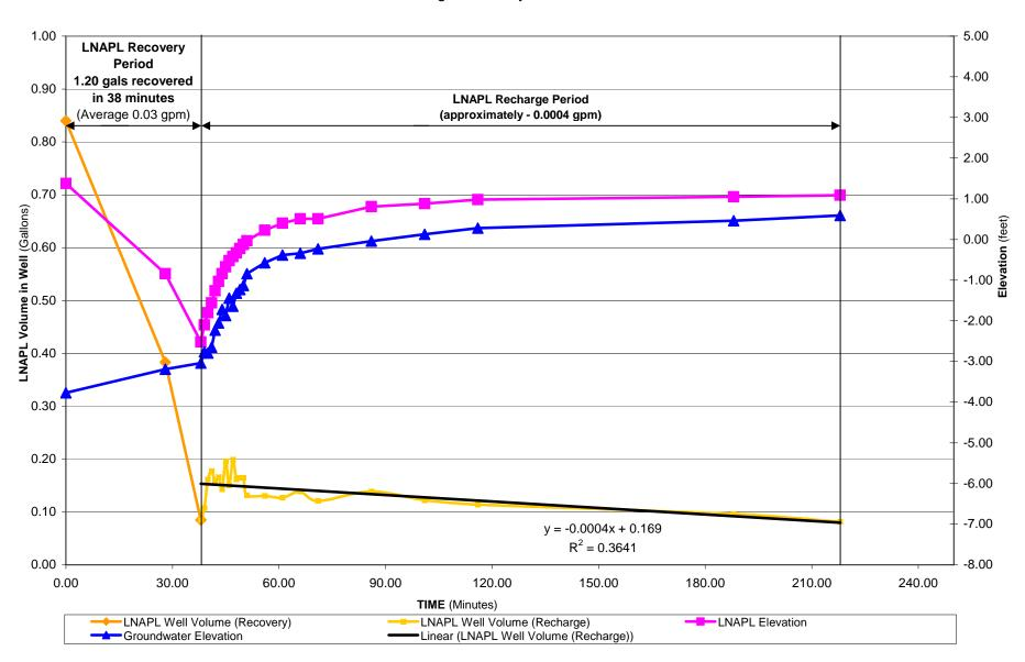
FIGURE 2 LNAPL RECOVERY Vs. TIME - MW-24
