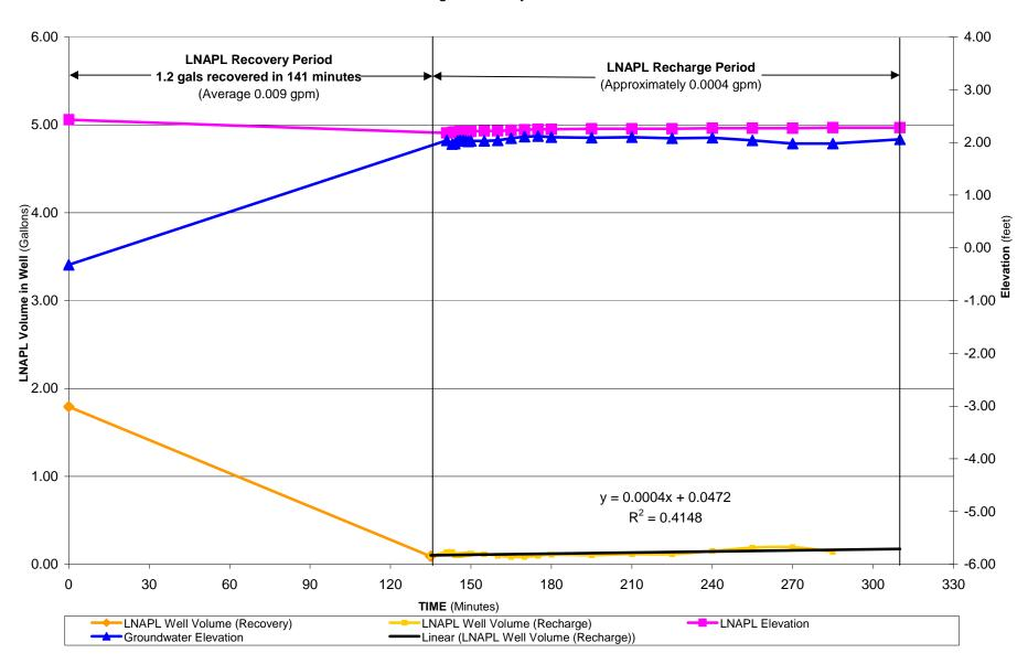
FIGURE 4 LNAPL RECOVERY Vs. TIME - MW-24
