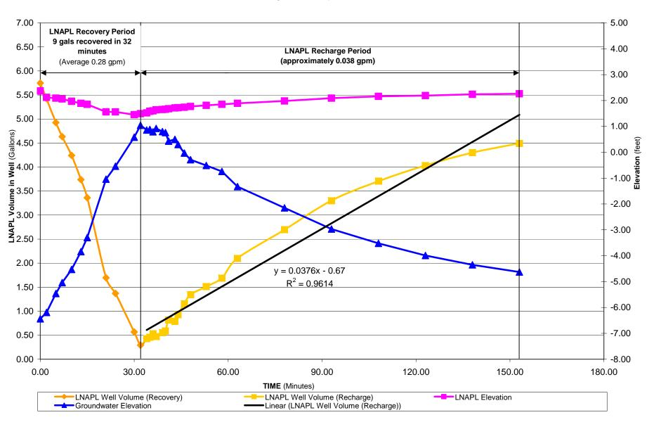
FIGURE 3 LNAPL RECOVERY Vs. TIME - MW-17
